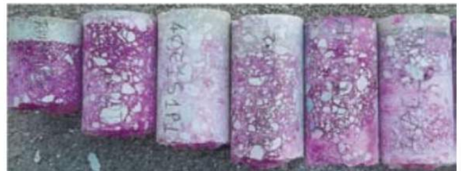
Carbonatation des échantillons de béton
