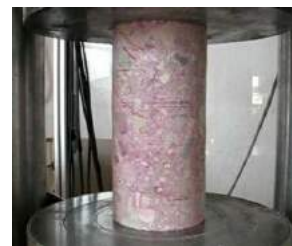
Tests de compression du béton (Échantillons cylindriques)
